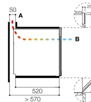
A: Per il ricircolo dell'aria è necessario un canale di dimensioni minime di 50 mm nella parte superiore del vano incasso.
