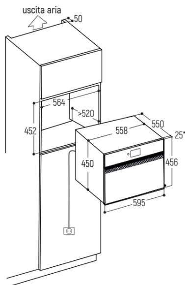
\*Spessore anta 25 mm: in caso di installazioni combinate, verificare lo spessore delle porte e delle ante degli elettrodomestici e/o mobili adiacenti per avere lo stesso allineamento
